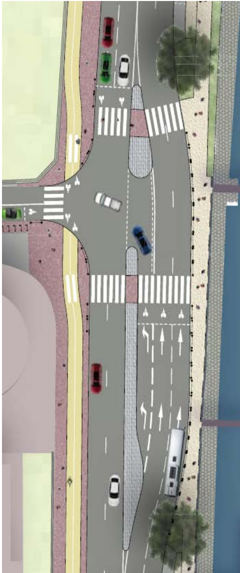
Croisement de l'avenue de Longchamp à Saint-Cloud Première proposition d'aménagement (avec file spécifique de tourne-à-gauche)
