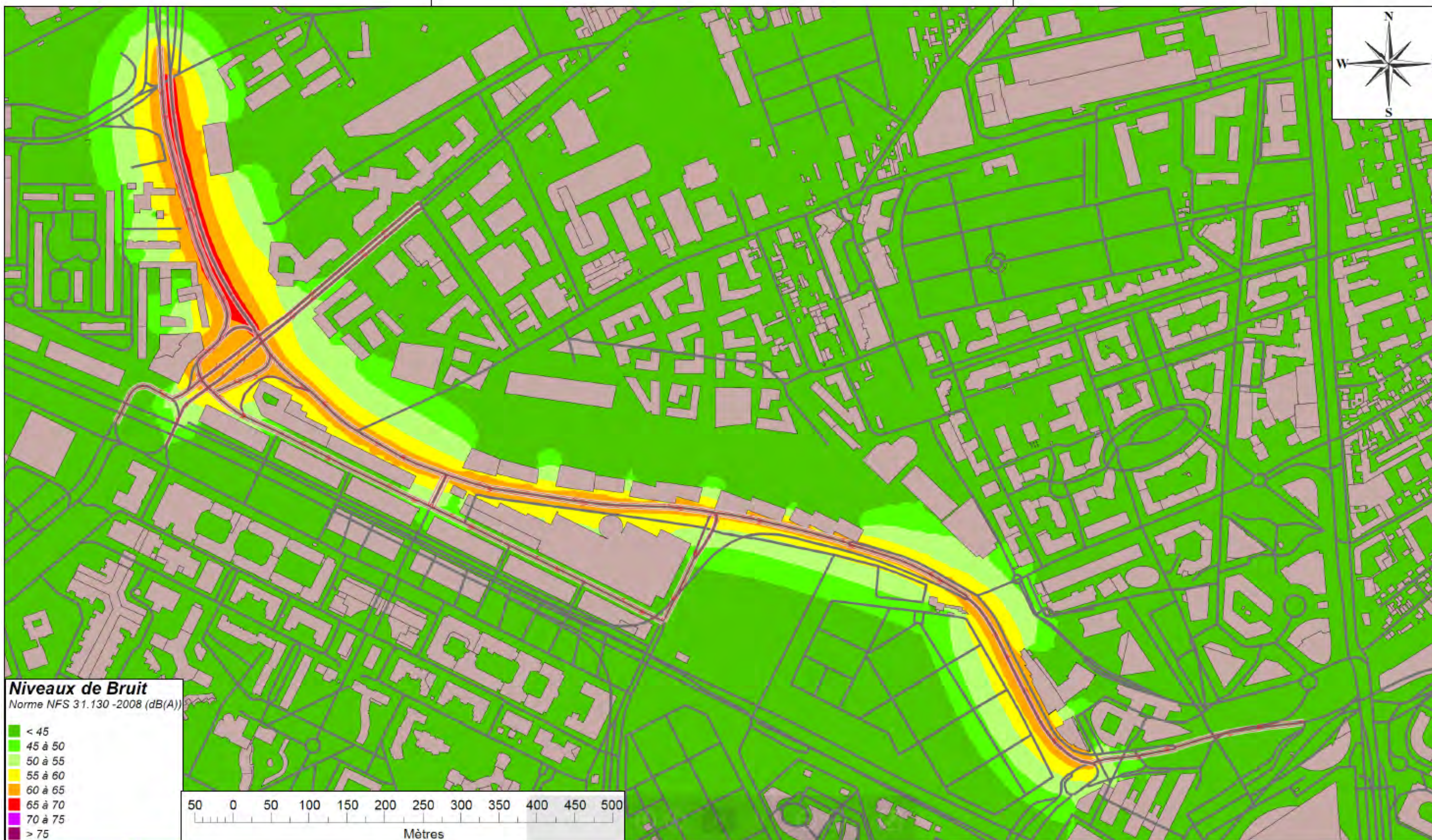
Contribution sonore SANS le projet 2040 – Carte de bruit à 4 mètres du sol – Période nocturne 22h-06h
