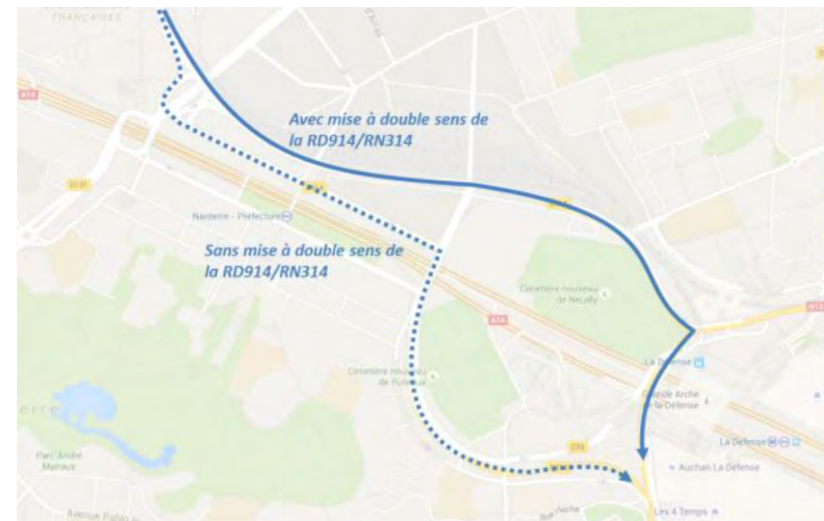
Figure 257 : Synoptique des flux de circulations avec et sans projet de mise à double sens de la RD 914 et de la RN 314
