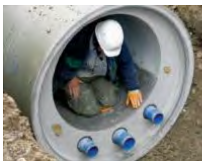
Echangeur intégré au collecteur lors de sa fabrication
